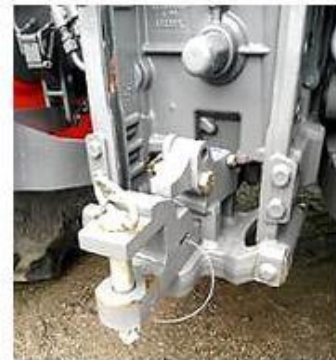
Chape d'attelage et Barre de traction
